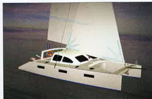
▲ Le Soubise 49 se présente comme un cata hauturier et rapide, proposé avec un mât aile en standard.
